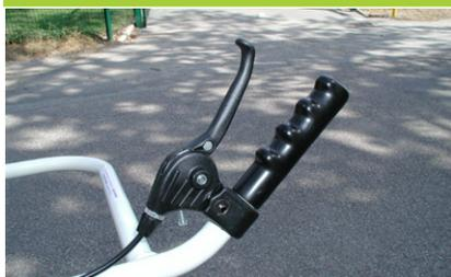
POIGNÉE «OUVERTURE FERMETURE» DU CLAPET DE LA CARTOUCHE
