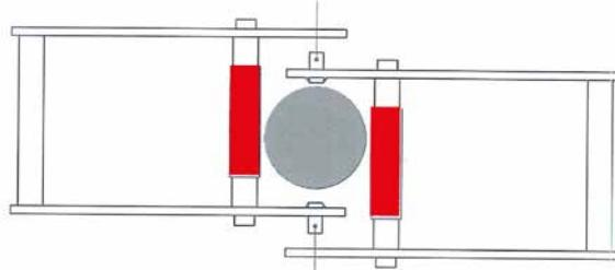
3 - Mise en place des axes dans les perçages. Mise en place des goupilles
