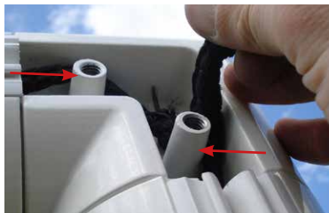
2 plots taraudés pour réception des 2 vis, et guidage du surjet du filet.
