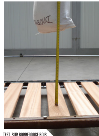
TEST SUR BARRERDAGE BOIS
