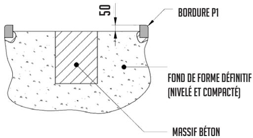
Nota : Les bordures P1 périphériques doivent être intégralement posées et le fond de forme définitif doit être nivelé et compacté à -5cm par rapport au niveau du sol fini.
